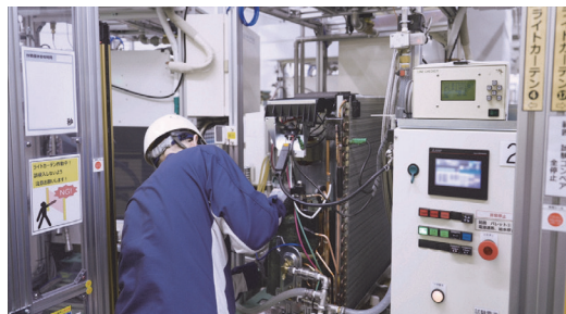
通電検査： 正常に作動するか かくにん 確認
